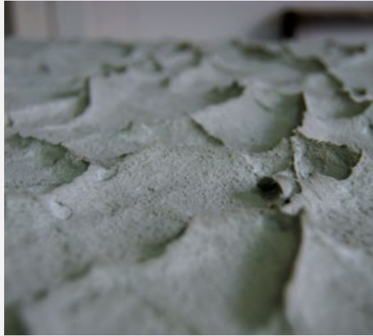
Dettaglio macro della prova di copertura di adesivo di categoria S1
