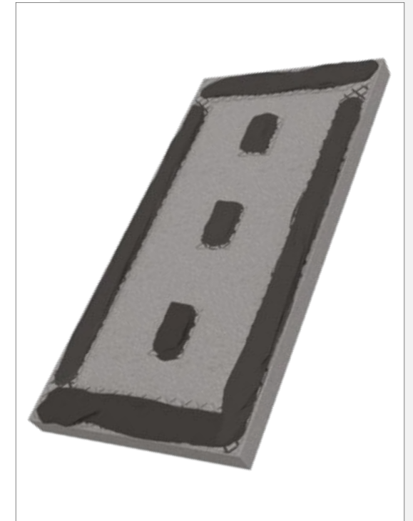
Applicazione del collante sul pannello secondo la tecnica "cordolo e punti"
