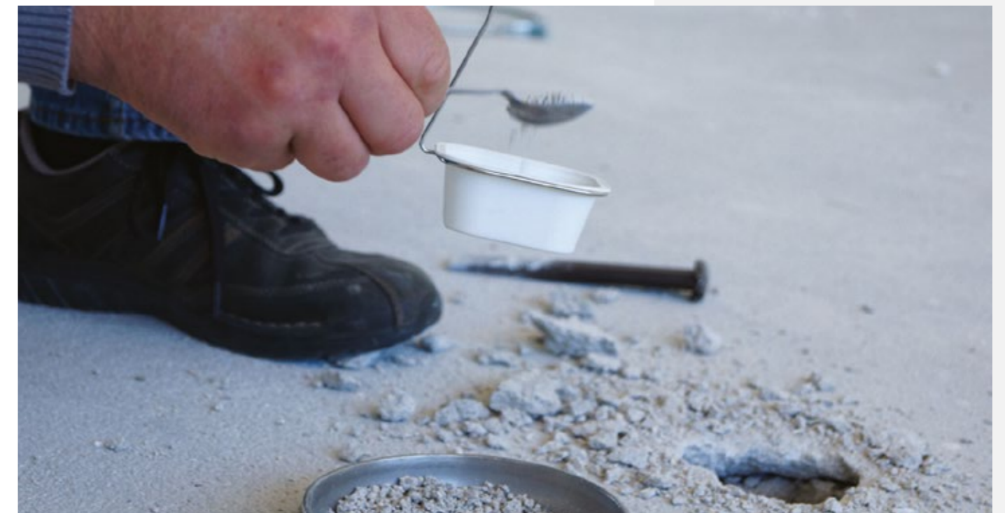
La corretta misurazione dell'umidità residua nel massetto è effettuata mediante Igrometro a carburo.
