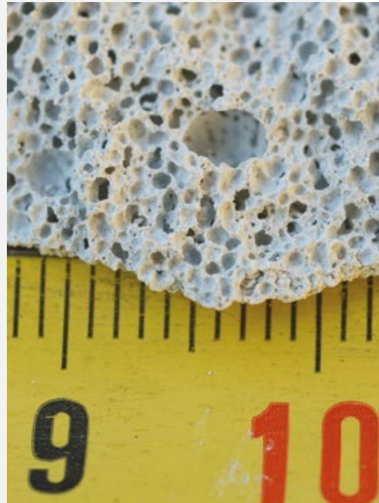
Il calcestruzzo cellulare ha una struttura porosa ed è costituito per l'80% da aria
